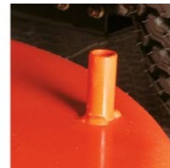
Podłączenie wody do agregatu koszącego ułatwia utrzymanie tego elementu w czystości
