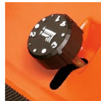
Centralna regulacja wysokości koszenia – obsługiwana z fotela operatora
